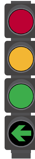
SEMÁFORO PARA GIROS PROTEGIDOS: Regula el tránsito de vehículos, indicando la posibilidad de dar vuelta a la derecha o izquierda, de acuerdo con la dirección de la flecha.
